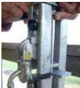
Figura 9.- Ascenso con dispositivo anticaídas deslizante
