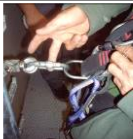
Figura 6.- Anclaje al dispositivo anticaídas deslizante
