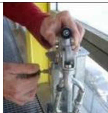
Figuras 11, 12 y 13- Giro de la parte móvil y extracción del carro del carril
