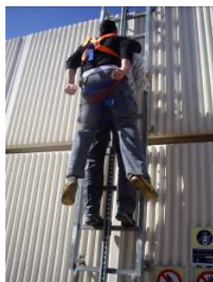
Figura 24.- Paso 3.- Pequeño impulso hacia arriba para desbloquear el dispositivo anticaídas deslizante
