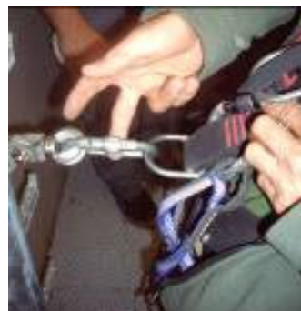
Figura 6.- Anclaje al dispositivo anticaídas deslizante
