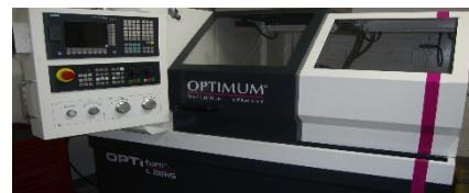
Un torno CNC puede hacer todos los trabajos que normalmente se realizan mediante diferentes tipos de torno. Su rentabilidad depende del tipo de pieza que se mecanice y de la cantidad de piezas que se tengan que mecanizar en una serie.
