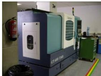
Gracias a la programación del CNC, se puede realizar el mismo proceso innumerables veces sin perder precisión, pudiéndose mecanizar los más diversos materiales, como madera, acero, fundición de hierro, metales no ferrosos y materiales sintéticos, superficies planas o curvas, de entalladura, de ranuras, de dentado, etc. Además, las piezas fresadas pueden ser desbastadas o afinadas en la misma operación.
