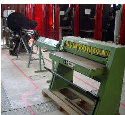
Puede estar instalada en una mesa/bancada y disponer de pedal de accionamiento.
