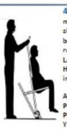
4º RECOJA LAS RUEDAS TRASERAS. Más o menos a 2 metros de la escalera, incline la silla hacia delante hasta apoyar sobre la barra delantera y empuje con el pie las ruedas para que queden recogidas INCLINE LA SILLA HACIA ATRÁS, EMPUJÁNDOLA HACIA LOS ESCALONES. Síntese en el lado interior de la escalera.
